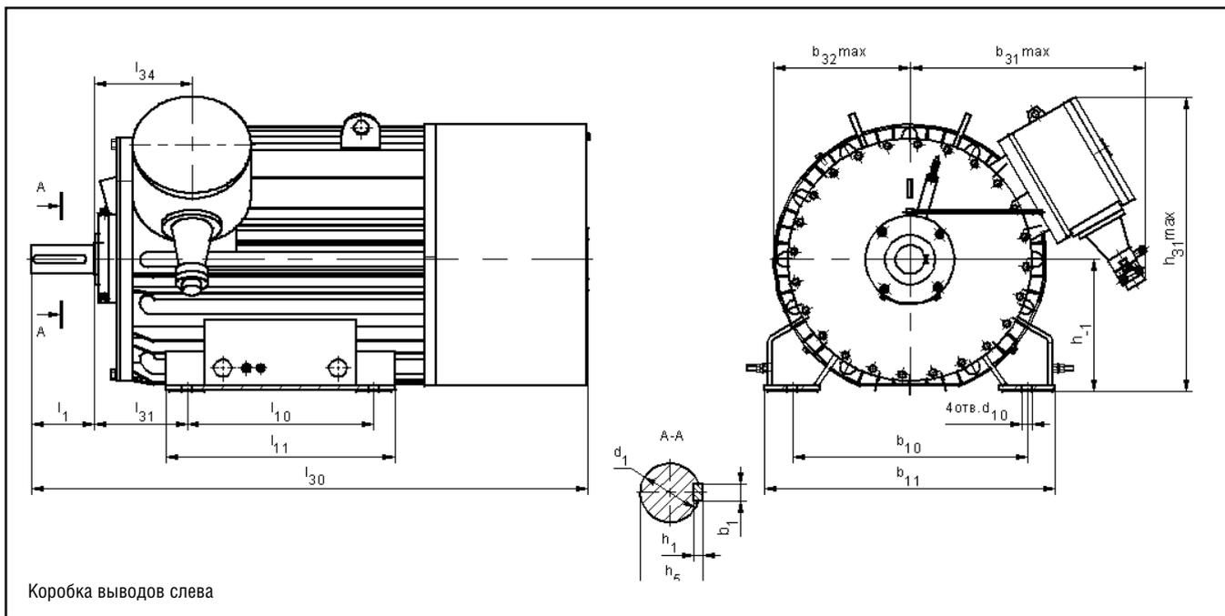
Габаритные, установочные, присоединительные размеры и масса высоковольтных двигателей 1BAO-450, монтажное исполнение IM1001
