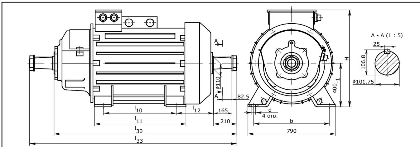
Габаритные, установочные, присоединительные размеры и масса двигателей 4МТНФ
