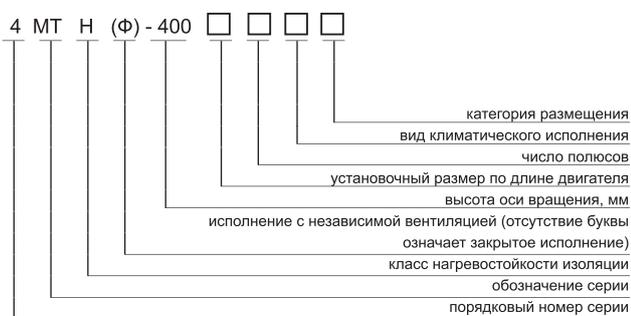
Электродвигатели асинхронные трехфазные с фазным ротором типа 4МТН-400 предназначены для работы на подъемно-транспортных механизмах и в электроприводе металлургических агрегатов. Двигатели предназначены для работы от сети переменного тока частотой 50 Гц напряжением 220/380 В, 380 В, 500 В и 660 В.
