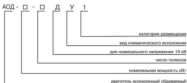
Электродвигатели асинхронные трехфазные с короткозамкнутым ротором серии АОД предназначены для привода механизмов, не требующих регулирования частоты вращения (насосы, вентиляторы, дымососы и т.п.) и других механизмов с аналогичными характеристиками при пуске.
