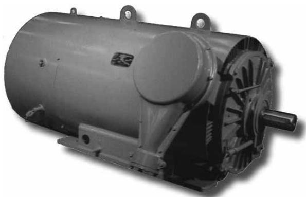
Электродвигатели асинхронные трехфазные с короткозамкнутым ротором типа АОМ предназначены для привода механизмов, не требующих регулирования частоты вращения (насосы, вентиляторы, дымососы) и других механизмов с аналогичными характеристиками при пуске. Не допускается применение двигателей для привода механизмов, работающих в режиме реверса.
