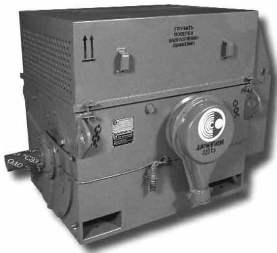
Электродвигатели асинхронные трехфазные с короткозамкнутым ротором серии ДАЗО4 предназначены для привода механизмов, не требующих регулирования частоты вращения (насосы, вентиляторы, дымососы и др.) Двигатели предназначены для работы от сети переменного тока частотой 50 Гц напряжением 3000 В, 6000 В и 10000 В.
