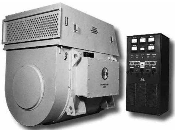
Генераторы синхронные типа СГ2-750/6,3 и СГ2-1000/6,3 с бесщеточной системой возбуждения предназначены для работы в составе турбогенератора, в качестве источника трехфазного переменного тока частотой 50 Гц напряжением 6300 В. Генераторы поставляются в комплекте с тиристорным возбудительным устройством (ТВУ).
