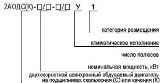
Структура условного обозначения двигателей типа 2АОД
