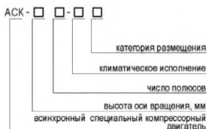
Структура условного обозначения двигателей типа АСК
