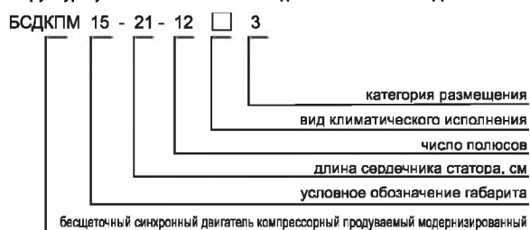
Структура условного обозначения двигателей типа БСДКПМ
