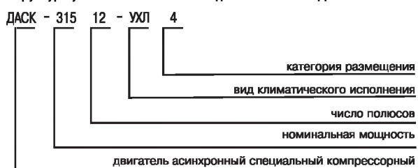
Структура условного обозначения двигателей типа ДАСК-315
